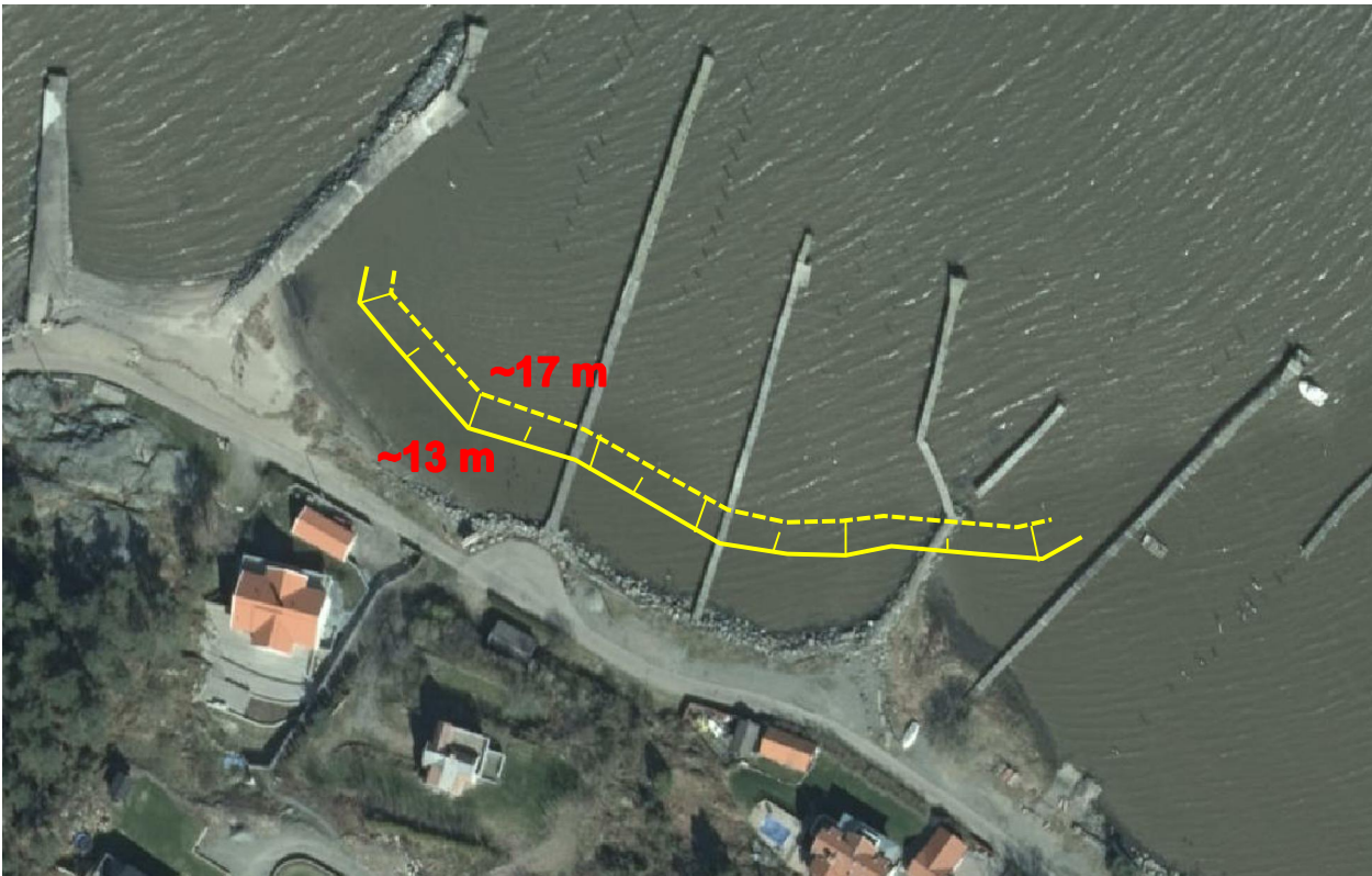
Figur 10: Principutförning muddringsgränser mot land. Släntlutning 1:3 mellan släntkrön och släntfot.
